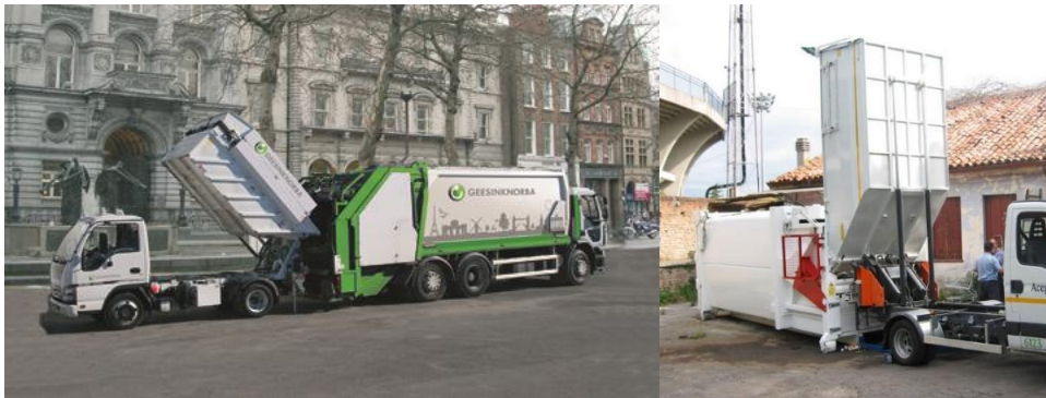
Figura 20 Ringarkimi nga automjeti mobil/satelitor (majtas) dhe ringarkimi në kontejnerin me ngjeshje (djathtas)
